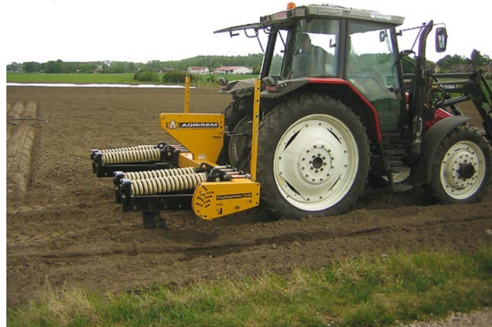
Redskapet för djupbearbetning sänks ner i marken och bearbetar jorden. I detta försök djupluckrades jorden i radmellanrummet ner till 55 cm djup efter sättning, strax innan uppkomst.
