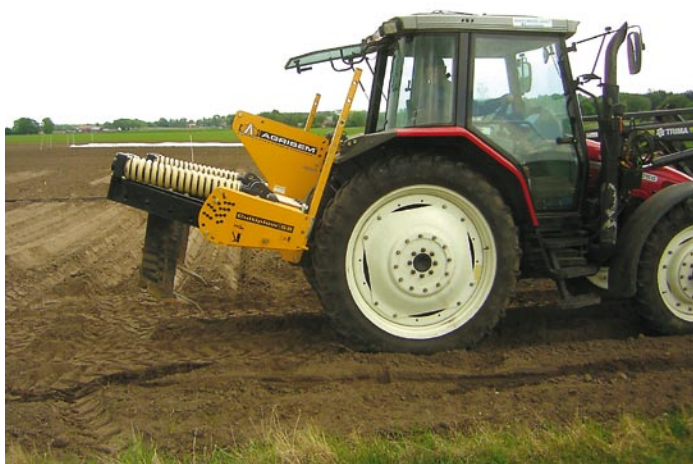
Redskapet för djupbearbetning sänks ner i marken och bearbetar jorden. I detta försök djupluckrades jorden i radmellanrummet ner till 55 cm djup efter sättning, strax innan uppkomst.
